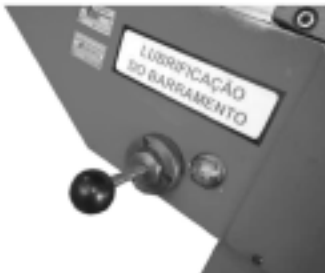
Bomba de lubrificação do Barramento
