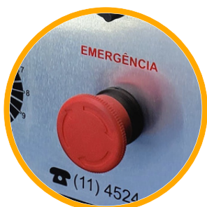
Botão de emergência
