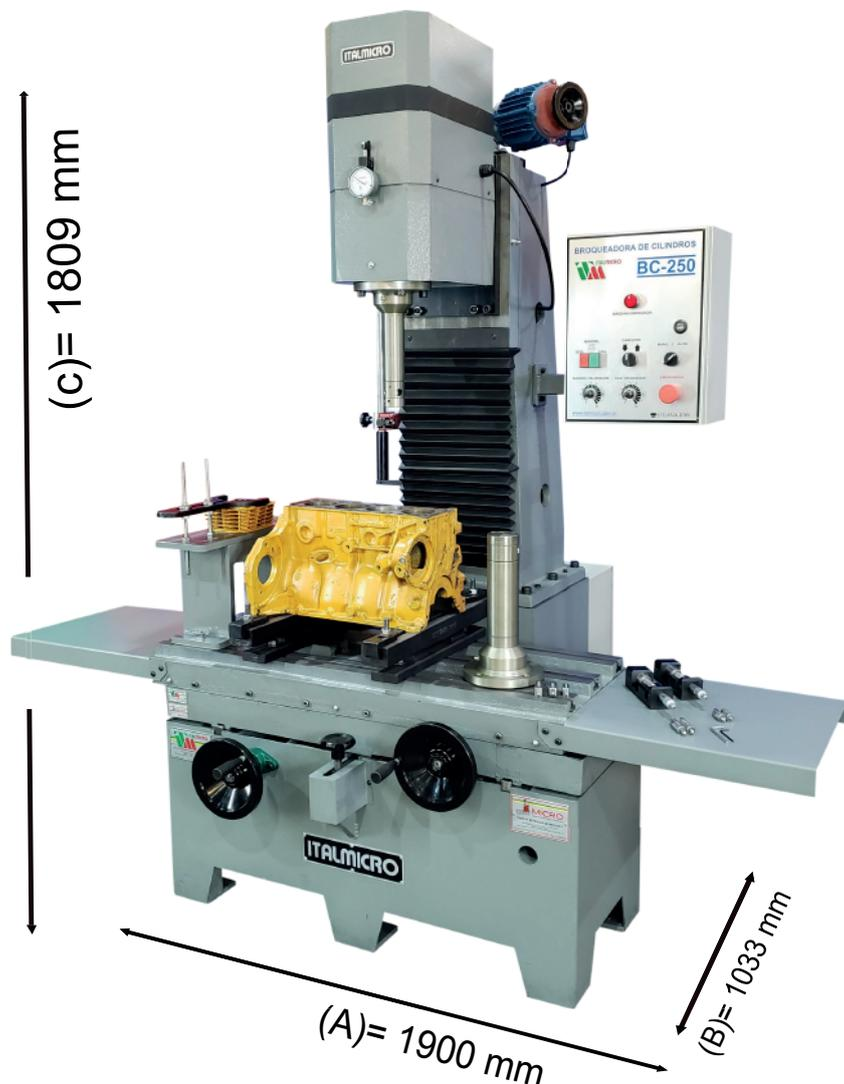
A Broqueadora de Cilindros BC Italmicro é a melhor solução para usinar blocos para sua retífica de motores.
