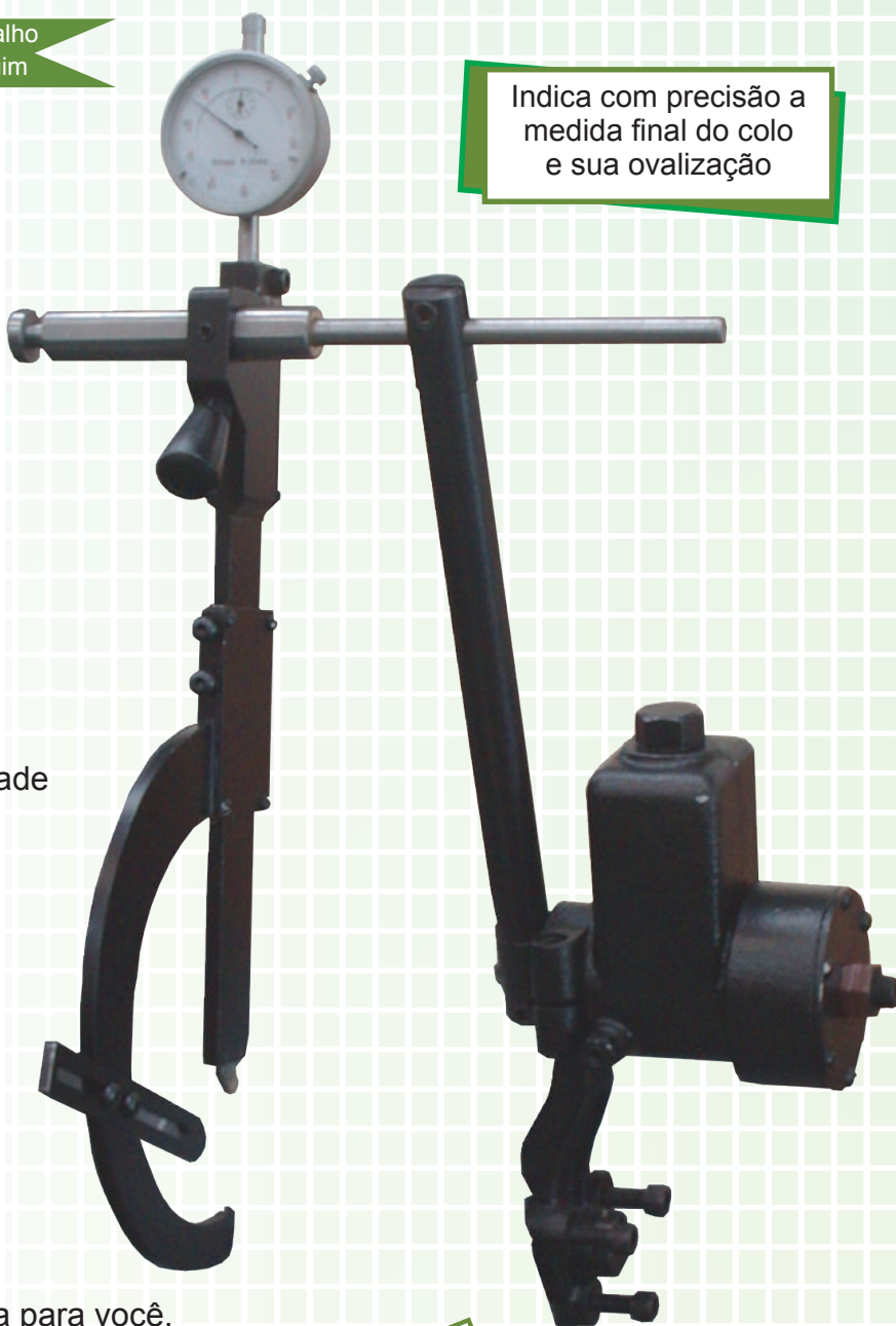
Micrômetro contínuo hidráulico desmontado
